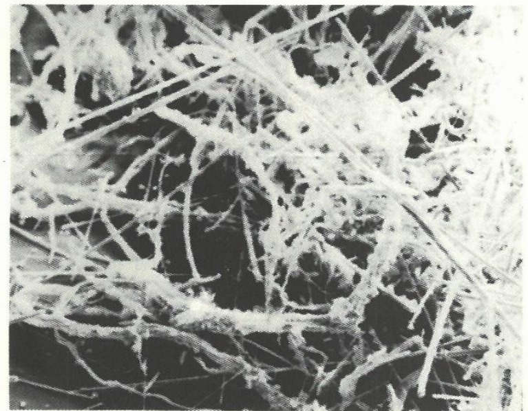
Photo agrandie d'un des échantillons prélevés au Tessin. Les longues fibres droites sont des fibres de verre. Les fibres courbes et emmêlées sont des fibres d'amiante chrysotile. Largeur de la prise de vue : environ 0,6 millimètres.
